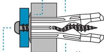
Полукруглая шляпка шурупа создает надежный прижим прикрепляемого изделия.
